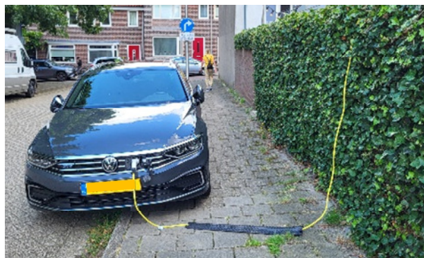
Kabel onder een kabelbrug
